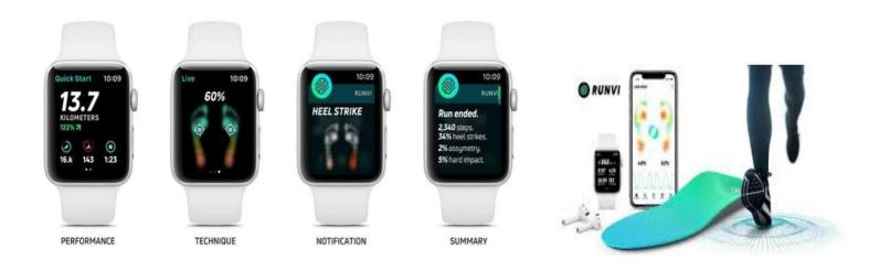
A l'intérieur des semelles petit sont présents 30 capteurs de pression, deux accéléromètres et une batterie bonne pour 8 à 10 heures de course. Ce produit sert a donner des conseil en analysant sa course et sa posture du corps , et donner aussi des programmes adapté.
