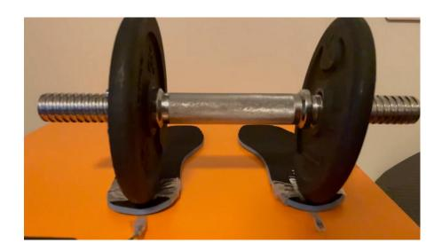
Ensuite dans le cas d'une position incorrecte avec l'inclinaison du poids droit, on peut voir sur l'interface graphique Processing que le poids supporté par le pied est supérieur au pied gauche, faut savoir que plus il y a du poids supporté par un capteur plus le cercle va prendre une forme elliptique allongé, sur le défilement des valeurs, on peut aussi voir que les valeurs du pied-droit son supérieur a celle du pied gauche
