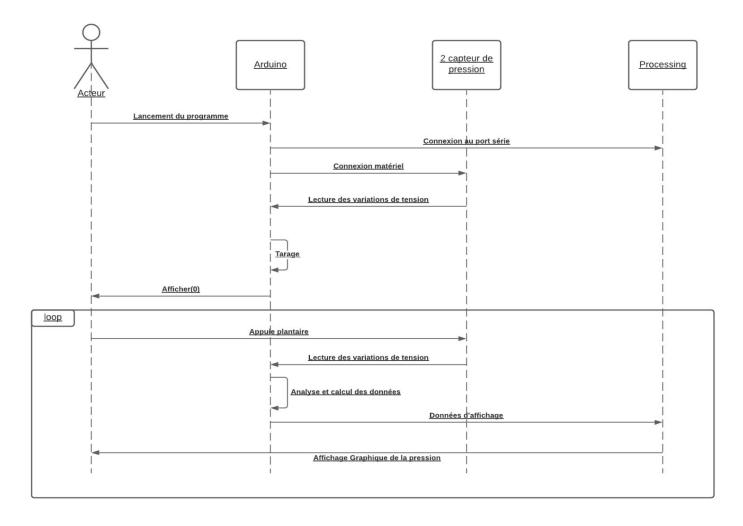
Tout d'abord, l'acteur lance le programme Arduino avec la vérification et le téléversement du code sur Arduino IDE, ensuite nous initialisons une communication série entre Arduino et Processing nécessitant la bibliothèque "processing.serial.\*" ou la Transmission des données sur le port Serial se fait à une vitesse de 9600 bits par seconde.
