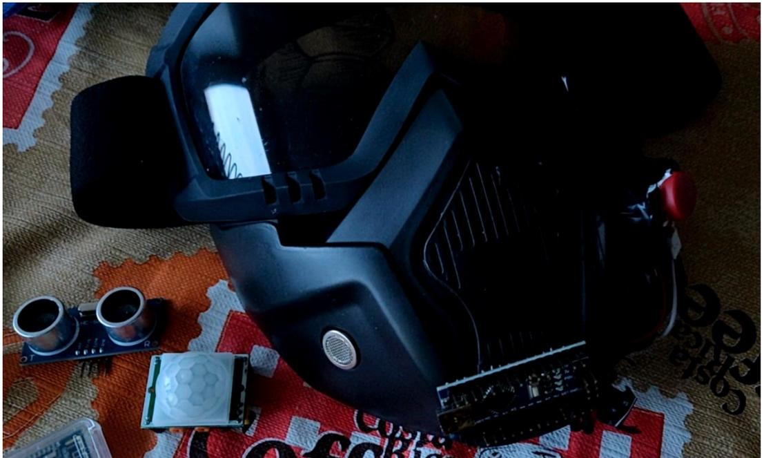
J'ai commencé donc par souder toutes les broches de l'Arduino Nano notamment les broches d'alimentation qui sera relire directement a deux batteries de 3.7v et 650 mAh) avec un interrupteur
