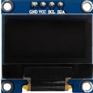
L'écran OLED I2C AZDelivery de 0,96 pouce est un écran à contraste élevé avec une haute résolution de 128 par 64 pixels et une technologie OLED innovante.
