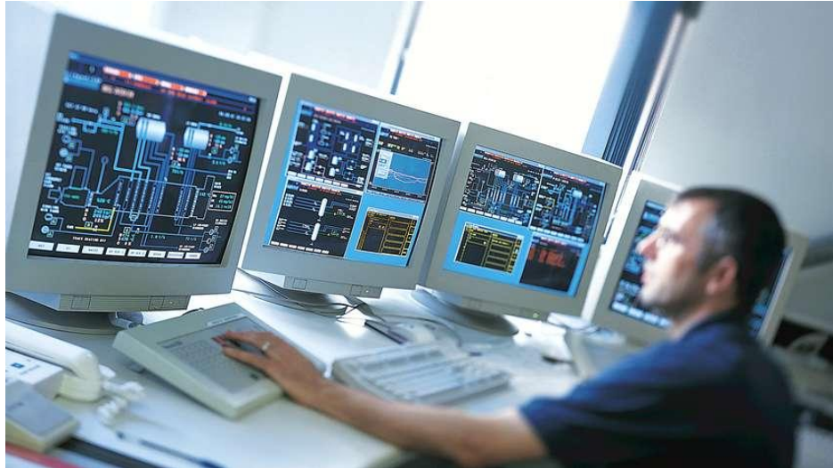
Figure n° 3: Les systèmes de contrôle distribués
